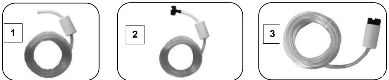
Figure 24. montage de la crépine d'aspiration
