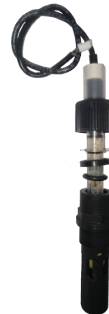
Figure 46 - Sonde pH+ORP dans sa chambre d'analyse
