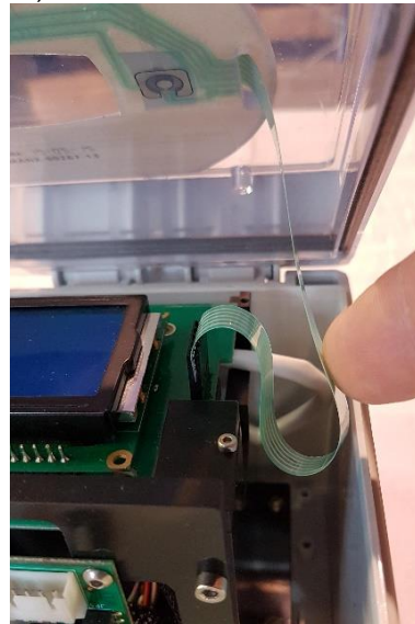
Figure 35 - Guidage de la nappe clavier
