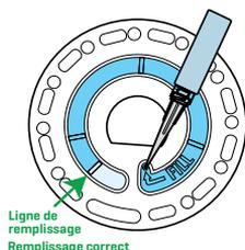
2. Ne remplissez pas trop le disque. Si le disque est trop rempli, l'eau d'échantillon débordera de la cavité de débordement située au centre du disque. Le disque ne fuit pas. Séchez le disque et lancez le test.
