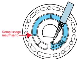
4. Ne créez aucune bulle d'air dans le disque. Les chambres de réactifs ne seront pas entièrement remplies et les résultats seront inexacts. Dès qu'une bulle commence à se former, tirez sur le piston pour tirer la bulle du disque. Recommencez le processus de remplissage.
