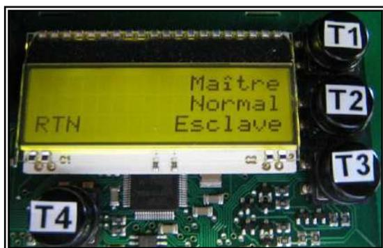
La boîte de contrôle peut-être en mode “maître” ou “esclave”. En standard la boîte de commande est en mode normal.
