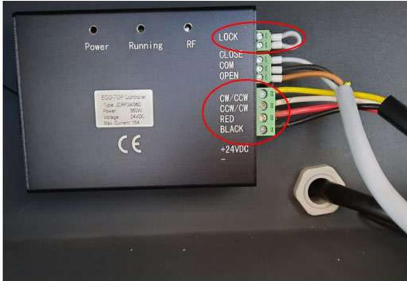
Réglez la direction de rotation avec l'interrupteur à clé. Si la direction de rotation est incorrecte, échangez les câbles sur CLOSE et OPEN.
