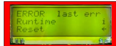
En cas de dépassement du temps autorisé, le message **Runtime** apparait. Attendre quelques minutes avant d'utiliser de nouveau le volet ou bien augmenter le temps max.
