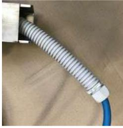
*Avant d'installer l'axe, retirer la protection du câble pour le transport. Faites bien attention lors de la manipulation du câble de ne pas le blesser sur l'inox au risque de laisser entrer l'eau par le câble.*
