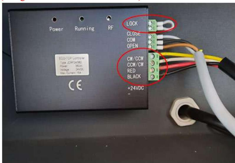
Câble connecté à l'alimentation 24V provenant des batteries connecter au contrôleur sur la ligne 24Vdc +/-
