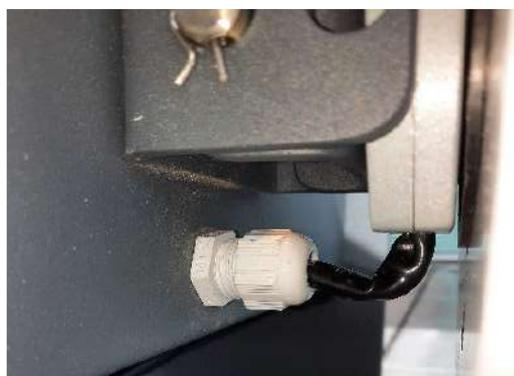
Connectez le câble du moteur comme indiqué ci-dessous. Retirer le cavalier sur "LOCK" uniquement pour faire fonctionner le couvercle en mode homme mort.
