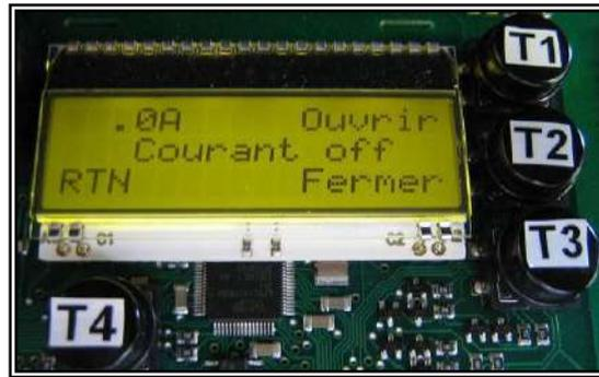
Ici vous pouvez observer le courant utilisé pendant l'ouverture et la fermeture de la couverture sans limite d'Ampérage. Si vous dépassez 20A, le fusible va casser pour protéger la carte.
