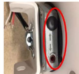
Le couvercle peut être actionné à l'aide d'un interrupteur à clé et/ou d'une télécommande. Si nécessaire, une antenne supplémentaire peut être montée pour augmenter la portée de la télécommande **Non conforme avec la norme NF P 90-308**. ATTENTION : Ne faites fonctionner la couverture que si vous avez une vue sur la piscine.
