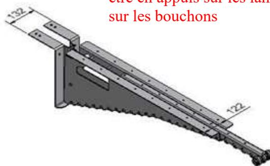
Attention, les roulettes doivent être en appui sur les lames et pas sur les bouchons
