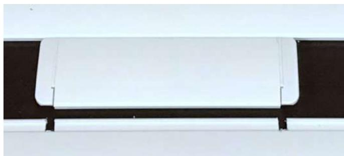
Ensuite, faire la découpe avec la scie de chaque marque pour faire une encoche et enlever la petite partie avec un cutter. Les encoches permettront aux lames de ne pas bouger transversalement. Assemblez les lames sur l'eau, positionnées devant les skimmer ou le refoulement.
