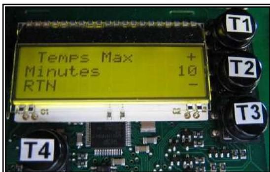
Temps de fonctionnement : Ici, vous pouvez décider du temps maximum pendant lequel la couverture peut être utilisée.
