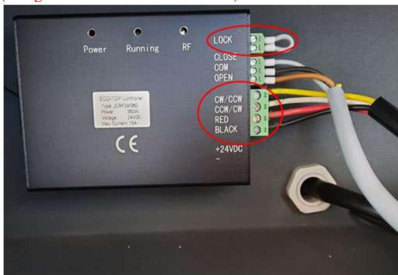
Câble relié à l'alimentation 24V (Dans le local technique) Connecter le contrôle à l'alimentation 24Vdc +/-.
