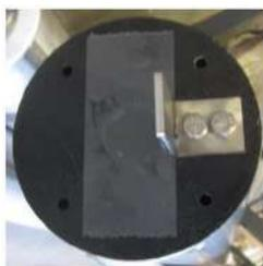
Sens de positionnement de la poutre ronde. L'équerre vient s'insérer sur le palier mural, et permet un blocage de la poutre dans le support en U.
