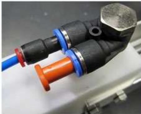
Pour éviter de pincer le tuyau d'air, on va faire tourner la pièce de manière à enrouler le tuyau autour du kit Top'Lock (n°5 sur image) – ainsi on peut entrer le kit dans la pièce à sceller sans pincer le tube d'air.
