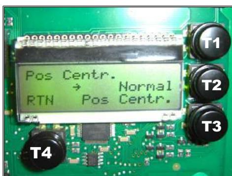
Sélectionner le mode Position . Appuyer sur T4 pour revenir au menu. Avec T1/T3 déplacer la couverture à la position désirée.
