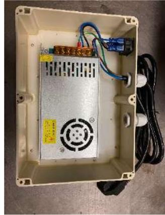
Si la fiche n'est pas connectée en usine, connectez l'alimentation 230Vac comme indiqué ci-dessous :  $\perp$  = jaune/vert, L = marron et N = bleu. Connectez le câble alimenté à la commande dans la console sur V+ et V- (24V en courant continu).
