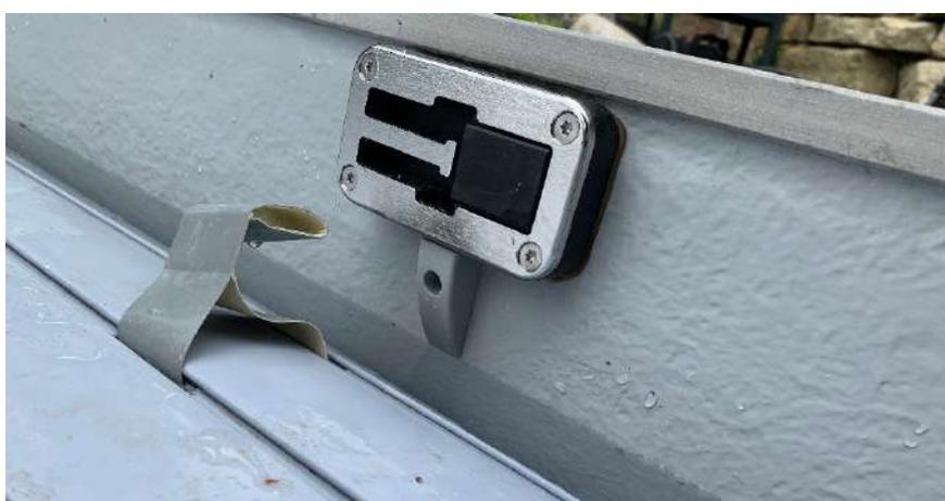
Utiliser la moitié d'une demi-lune comme déviateur sous la boucle de sécurité (côté mécanisme), pour éviter un blocage lors du déroulement.
