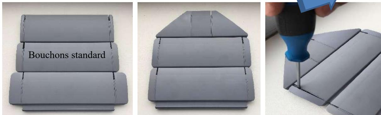
Le démontage d'un bouchon se fait avec un tournevis plat taille moyenne. Insérer le tournevis dans l'ergot et incliner le tournevis. Le bouchon va s'éjecter de la chambre.
