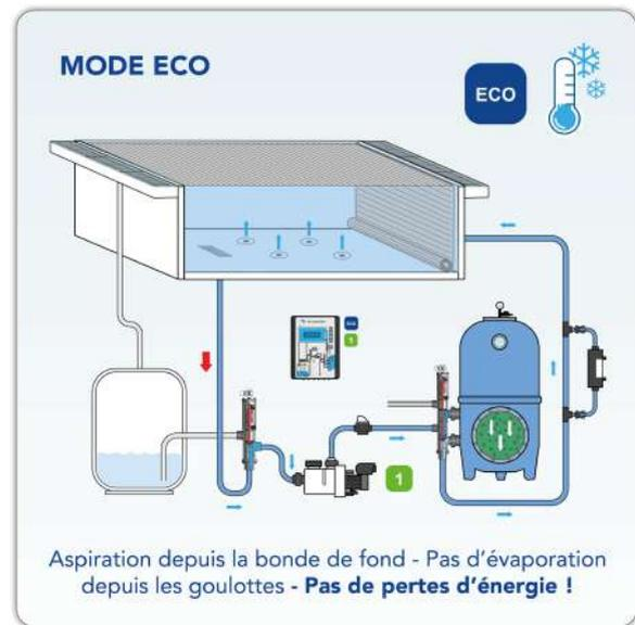
Avec l'installation d'une **vanne Besgo 3-voies** et d'un **AS Control Plus**, l'eau peut être aspirée en fonction de la température extérieure soit par les goulottes de débordement, soit par la bonde de fond.
