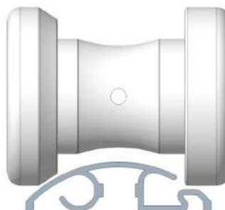
Mettre en contact l'épaulement de la roue avec la rainure du rail.
